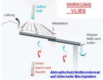
Das trifft dann zu, wenn keine entsprechende Durchlüftung, also keine ausreichende Luftzirkulation gegeben ist. Oft sind aber auch Bauten mit einer möglichst großen Dachneigung und dazu entsprechender guter Bedingungen für einen ständigen Luftaustausch aus konstruktiven bzw. standortbedingten Gründen nicht möglich bzw. vorhanden, wodurch das Abtragen von Luftfeuchtigkeit unterhalt der **Blechplatten** z.B. durch Wind nicht realisierbar ist.
