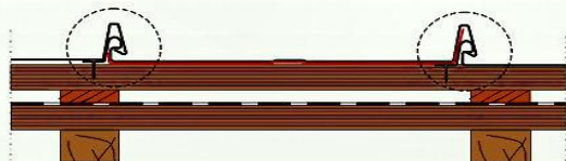
Abb. 15 Ausschneiden der Verschlussstellen
