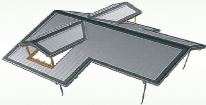
Abb. 7 Außenzonen sind Windeinwirkungen besonders ausgesetzt
