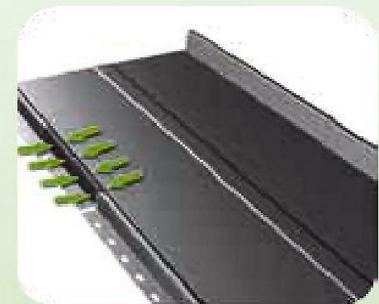
Abb. 19 Nach dem Anpassen der Paneele, die Verbindungsstellen entsprechend bearbeiten.
